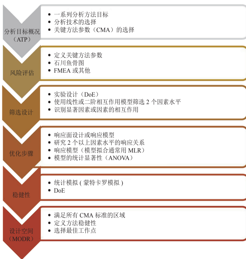
图2 基于QbD的分析方法开发(AQbD)工作流程的主要步骤 [43]
