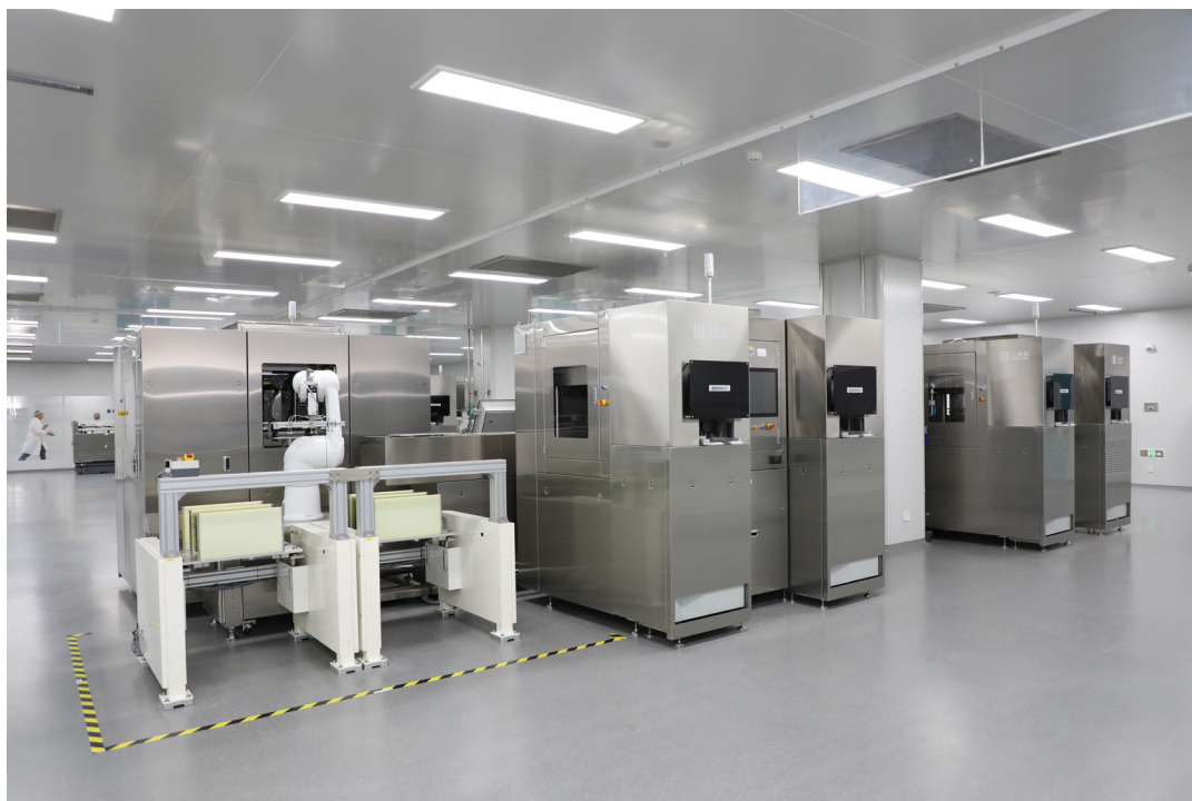
图 3 三迭纪基于热熔挤出沉积技术的 3D 打印连续化生产线
